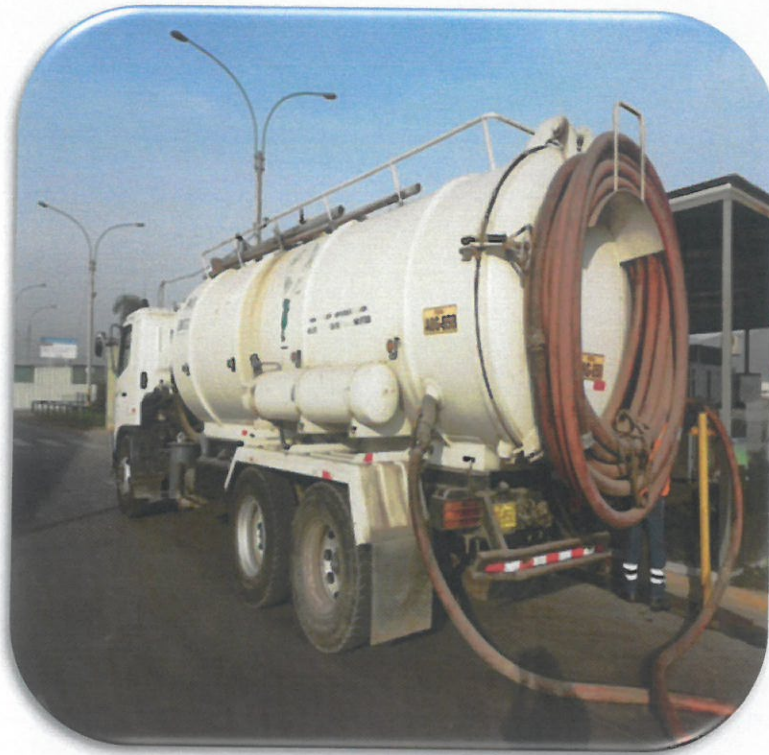
Camión cisterna succionador
